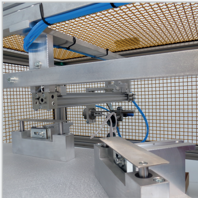
SISTEMA DI SCARICO AUTOMATICO E CHIUSURA OCCHIALE AUTOMATIC SYSTEM TO CLOSE THE GLASSES' ARMS DURING THE DISCHARGING OPERATION
