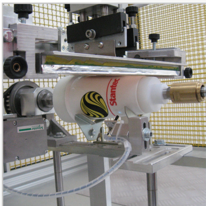
REGOLAZIONE REGISTRO A MEZZO SENSORE E FOTOCELLULA REGISTER ADJUSTING WITH SENSOR AND PHOTOCCELL
